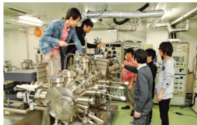
この研究では、半導体材料の結晶を成長させる「シリコン分子線エピタキシー(MBE)装置」(写真)で、とにかくよい試料を作ることが、成功のカギを握ります。そのため、メンテナンス作業も学生総動員で行われます。
